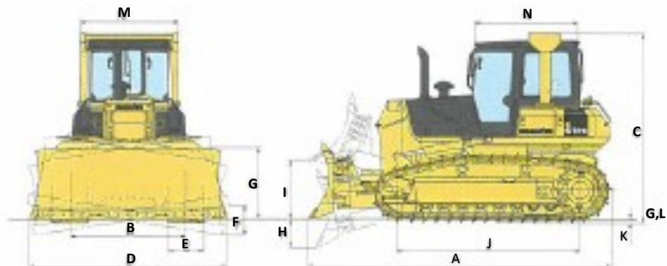
Dimensions avec lame PAT droite (D61 Train long/PX-15)
