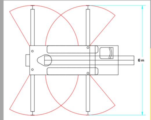
Rayon d'encombrement lors du déploiement des stabilisateurs parallèles au sol avec semelles relevées
